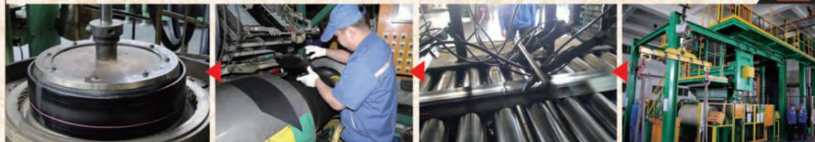
↑溝のないタイヤの原型=生カバーを金型に入れてタイヤに仕上げる。金型は世界的に品質が認められている台湾製だ。
