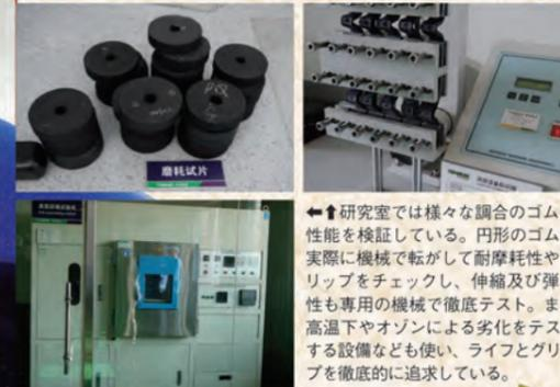
↑研究室では様々な調合のゴムの性能を検証している。円形のゴムは実際に機械で転がして耐摩耗性やグリップをチェックし、伸縮及び弾力性も専用の機械で徹底テスト。また高温下やオゾンによる劣化をテストする設備なども使い、ライフとグリップを徹底的に追求している。
